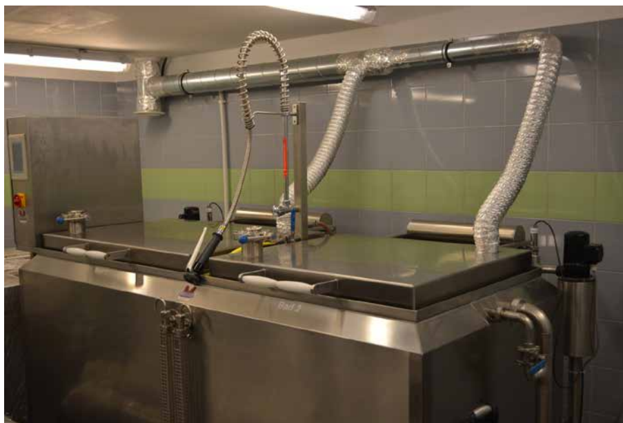
Ryc. 8. Macerator tkankowy – urządzenie do chemicznego odtłuszczenia kości w Zakładzie Medycyny Sądowej Śląskiego Uniwersytetu Medycznego w Katowicach (jedyna fotografia, jaka została nadesłana w odpowiedzi na apel o nadsyłanie zdjęć wyposażenia pracowni w innych ośrodkach)
