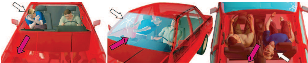
Ryc. 4. Mechanizm urazu wyprostnego kręgosłupa szyjnego w wyniku niezapięcia pasów bezpieczeństwa i ominięcia zagłówka w sytuacji zderzenia narożnikowego ze zmianą kierunku działania sił bezwładności (I) w drugiej fazie wypadku („odbicie” pojazdu od przeszkody).
